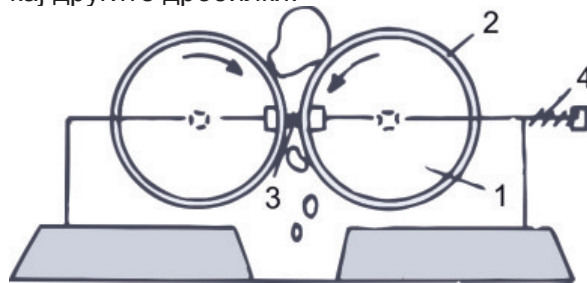
Слика 3. Шематски приказ на дробилка со валци. 1. валци, 2. облога на валците, 3. навои за регулација на растојанието меѓу валците, 4. заштитен федер.
