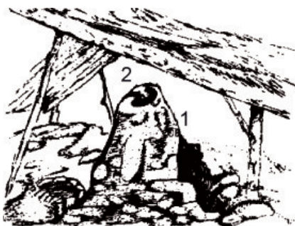
Слика 24. Добивање челик со постапка „грно“. 1. отвор на огништето, 2. отвор за руда и за јаглен.
