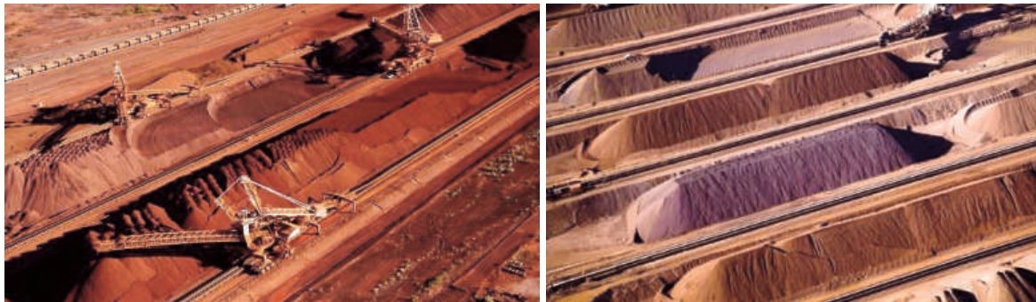
Слика 11. Распростирање на рудна греда (а – уред за распростирање на рудата, б – рудна греда).
